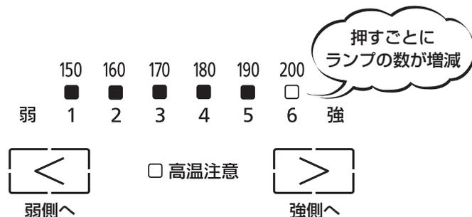
例) ・火力設定4の場合 火力表示ランプ1～4が点灯 ・火力設定6の場合 火力表示ランプ1～6が点灯
