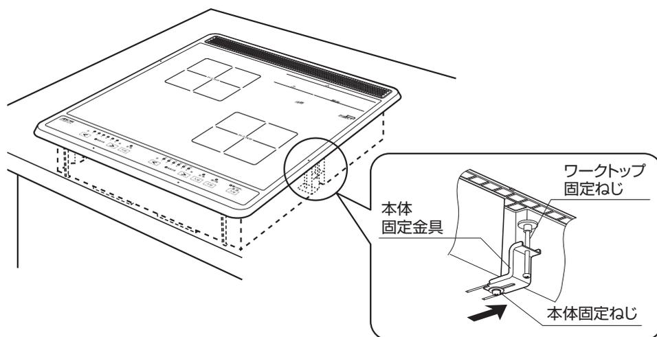
●本体固定ねじ締め付後にワークトップ固定ねじを締めつけてください。
