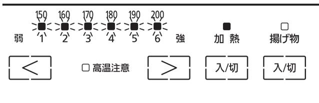
**5** 確認したらすぐに加熱キー  入/切 を押して通電を止める
