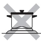
なべ底がデコボコしているものや曲がっているもの、なべ底が薄いものは、なべ底のヒーターとの接触が少なく熱効率が悪くなったり、安定性がなく危険です。
