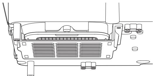
※フィルターを押し込み過ぎると、本体吸気口とフィルターがずれて、本体内部にほこりが入って故障の原因になります。
