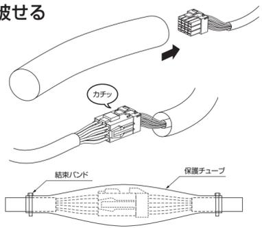
※接続コードは別売品延長ケーブル (SAP-924C) を使用することで2mまで延長可能です。延長コードを使用する場合は、コネクタ接続部 (2ヶ所) に保護チューブを被せて結束バンドで固定してください。
