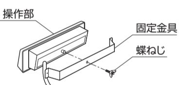
②操作部をキッチン開口より挿入し、キッチンの操作部取付穴から引き出す。
