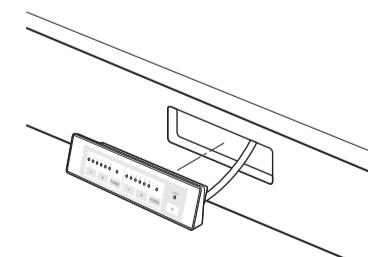
④キッチン内側より、操作部固定金具を取り付け、蝶ねじで締め付ける。
