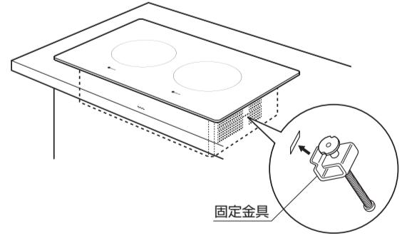
●固定金具のねじを確実に締め付ける。
