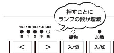
例)・火力設定「2」の場合 火力表示ランプ弱～2が点灯 ・火力設定「強」の場合 火力表示ランプ弱～強が点灯
