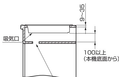
仕切り板を付ける場合は、仕切り板の前方に開口を60cm<sup>2</sup>以上の開口を設けてください。
