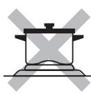
なべ底がデコボコしているものや曲がっているもの、なべ底が薄いものは、なべ底のヒーターとの接触が少なく熱効率が悪くなったり、安定性がなく危険です。
